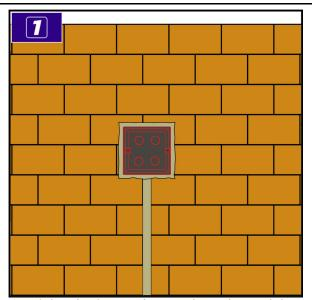
1. Bei der Platzierung der Wand / Bodensteckdose sind die Maße der Unterputzdose |2| zu beachten. Ist die korrekte Position der Unterputzdose bestimmt, markieren Sie deren Lage genau. Im nächsten Schritt sorgen Sie für die passende Vertiefung zum Einsetzen der Dosen.
