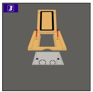
3. Nachdem der Schnellbaumörtel ausgehärtet oder der Estrich betretbar ist, setzen Sie den Deckel |1| auf und befestigen diesen mit zwei Schrauben an der UP |2|.
