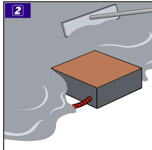
2. Die Leerrohre bzw. entsprechenden Leitungen sind vorab vorzubereiten / zu legen. Befestigen Sie die Leitungen bevor der Estrich verlegt wird. Verlegen Sie den Estrich. Optional können Sie in den Boden der Montage-Box [9] Löcher bohren und den Bodentank so mit der Unterkonstruktion Ihres Bodens verschrauben. Dazu verwenden Sie am besten EPDM-Schrauben mit Gummidichtung.
