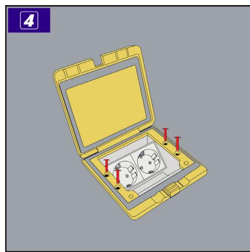
4. Jetzt können Sie den zusammengebauten Bodentank in die Montage-Box [9] einsetzen und die Stromleitungen an die Stromanschlussdose [8] anklemmen. Abschließend kann der Bodentank mit der Unterputzbox verschraubt werden. Dafür öffnen Sie den Deckel [1] und schrauben diesen mit den 4 beigelegten Schrauben fest.
